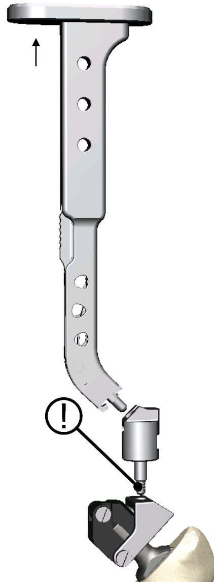
Abbildung 10: Schaft-Repositionierer mit Adapter modular und Raspelhandgriff gerade in notwendiger Ausrichtung zum Implantat
