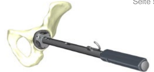
Abbildung 8: Implantation Pfanne mit geradem Griff
